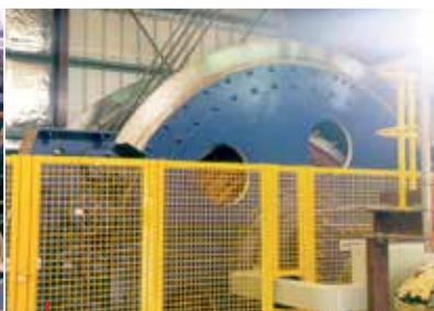
4-linowa maszyna wyciągowa w systemie Koepe
